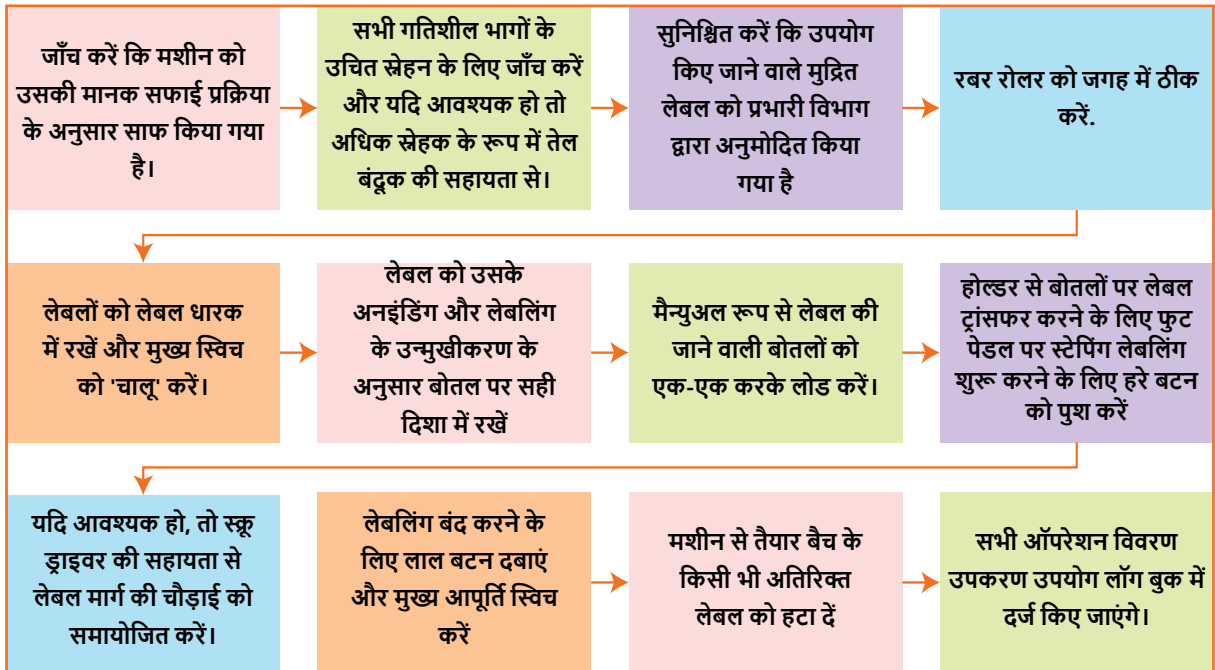
चित्र 22.2.1 लेबलिंग मशीन में लेबल लोड करने की मानक प्रक्रिया।
