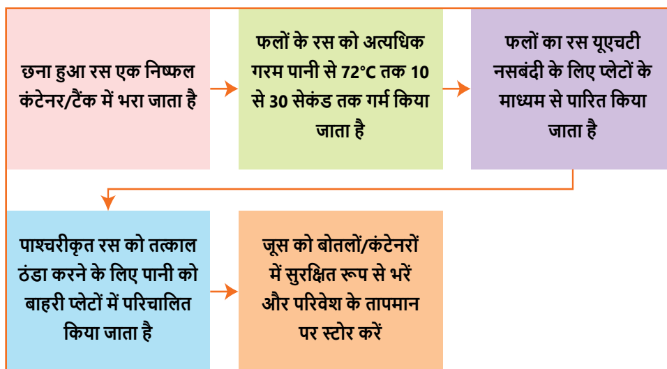
चित्र. 16.1.5 प्लेट पाश्चराइज़र मशीन का सुचारु संचालन
