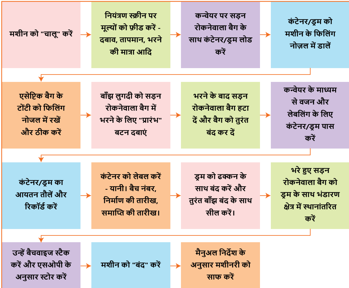
चित्र 6.1.7 एसेटिक फिलर मशीन की सुचारुप्रक्रिया
