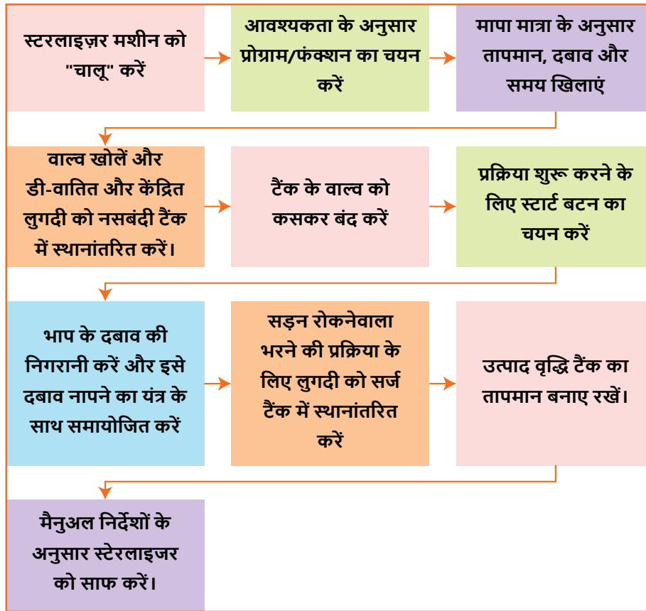
चित्र 6.1.4 एसेटिक स्टरलाइज़र मशीन की सुचारु प्रक्रिया
